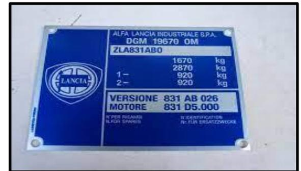
**FOTO TARGHETTA** di identificazione dei numeri di telaio e motore - DGM se presente
